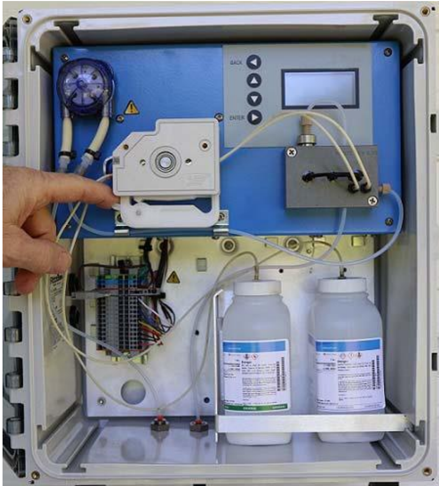
Bild 4.11 Vollständige Montage der Reagenzschläuche und Spannen der Platte
