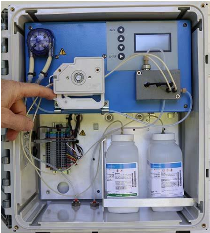
Bild 8.4 Vollständige Montage der Reagenzschläuche und Spannen der Platte
