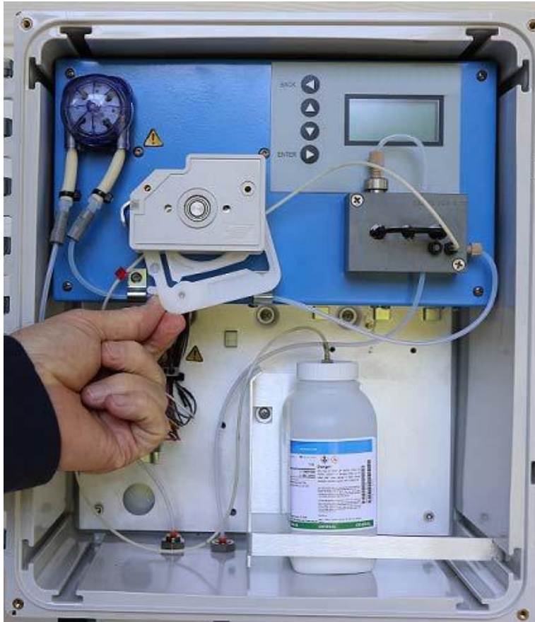
Bild 8.3 Installation des Pufferreagenzschlauchs
